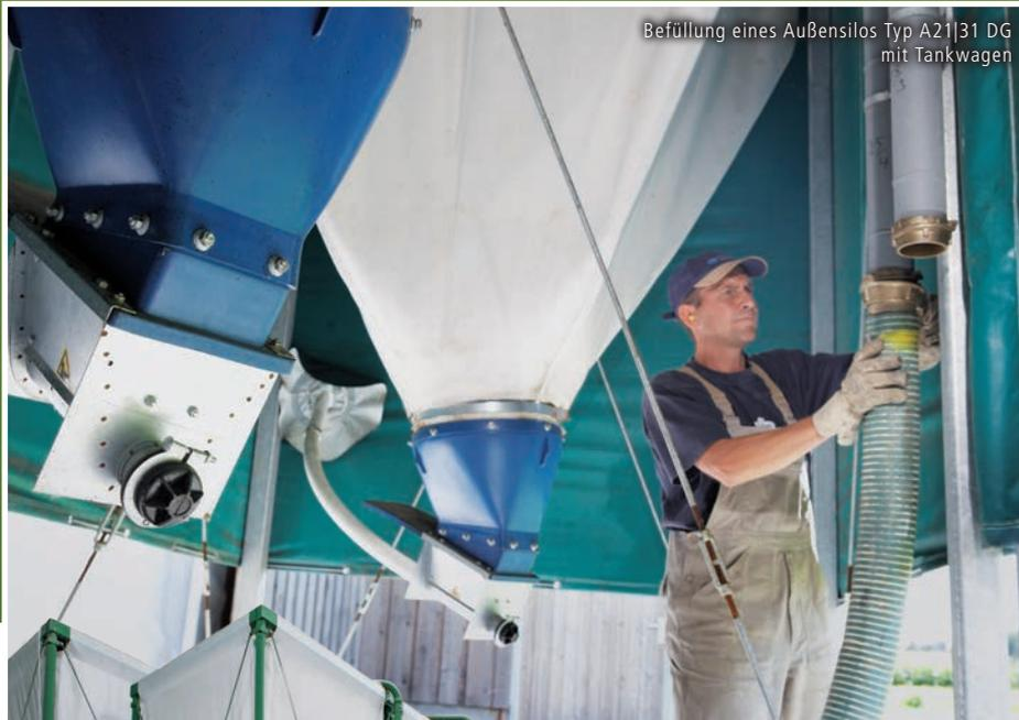
Befüllung eines Außensilos Typ A21|31 DG mit Tankwagen
